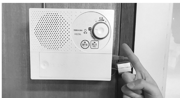
防災行政無線の屋内ユーザー受信機
