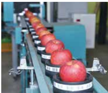
計測トレーに乗せられたりんご。光センサーで瞬時に等級分けされていく
