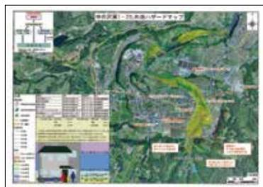
▲ため池の堤体が決壊した場合に何分後に何センチの深さの水がどの範囲に流れるかを示した「ため池ハザードマップ」
